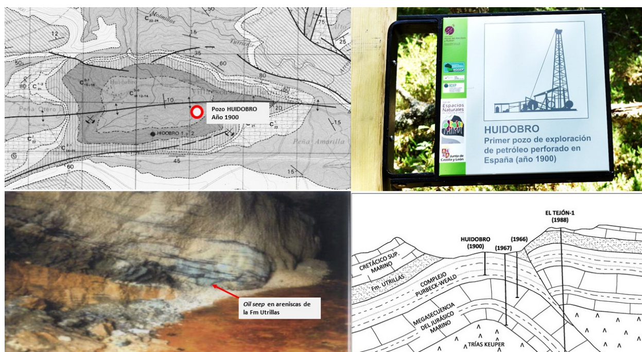
Figura 3. Anticlinal de Huidobro (mapa y corte geológico), rezumes de petróleo en las areniscas de la Fm Utrillas (megasecuencia Albo-Cenomaniense) y cartel indicando el emplazamiento del pozo Huidobro (perforado en el año 1900), el primero profundo perforado en España para investigación de petróleo.
